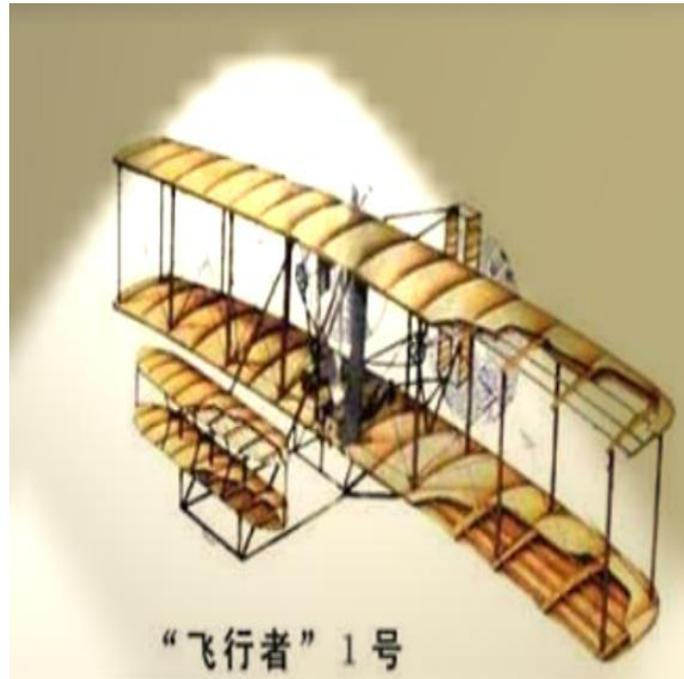
**简介:** 1903 年 12 月 17 日, 莱特兄弟成功试飞世界首架飞机 “飞行者一号”。此飞机依靠自身动力, 机身重于空气, 实现完全受控且持续滞空。他们首创的飞行控制系统, 让飞机得以受控飞行, 这项技术沿用至今, 广泛应用于各类飞机。莱特兄弟的伟大发明, 彻底革新人类交通、经济、生产与日常生活, 也改写了军事史。
