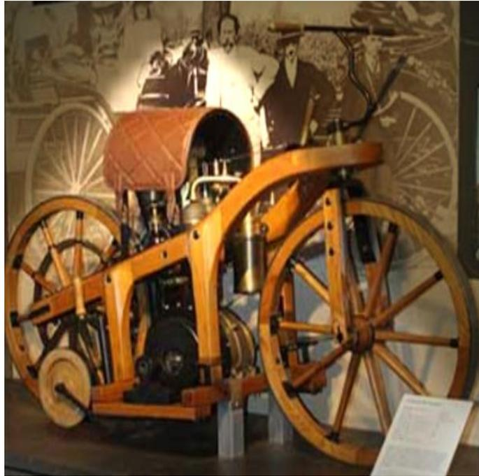
**简介：**1885 年 8 月 29 日，戈特利布·戴姆勒将改良后的汽油引擎安装于一辆木制两轮车上，成功制造出世界上第一辆摩托车，并取得发明专利。这辆摩托车基本沿用木制自行车结构，搭载由戴姆勒与其搭档威尔赫姆·迈巴赫共同开发的“老爷钟发动机”，该发动机为单缸设计，最大功率仅 0.5 马力，最高时速可达 12 千米 / 小时。1885 年 11 月 18 日，戴姆勒之子保罗驾驶这辆摩托车完成首次长距离行驶，行程约 12 公里。
