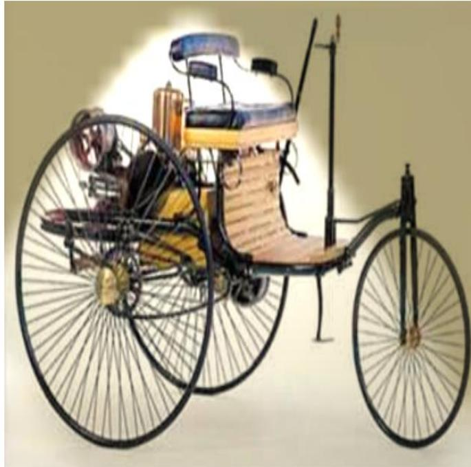
**简介：**1885 年，德国人卡尔·本茨成功研制出世界上第一辆装配单汽油机的木制三轮汽车。该车搭载一台两冲程单缸、功率为 0.9 马力的汽油发动机。此款三轮车已具备诸多现代汽车的关键特征，如采用火花点火系统、配备钢管车架、设有水冷循环装置、运用后轮驱动方式、装配钢板弹簧悬架以及前轮转向结构等。这些开创性设计，为现代汽车工业的发展奠定了坚实基础。
