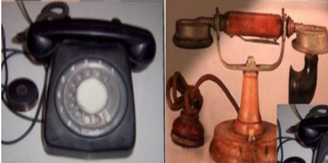
**简介：**电话机由美国人 A. G. 贝尔于 1876 年发明。他以两根导线连接两个结构一致、电磁铁上装有振动膜片的送话器与受话器，首次达成两端通话，只是当时通话距离短且效率低。1878 年，炭精送话器问世，大幅提升电话机送话器效率，受话器结构也得到改良。早期的磁石电话机依靠自备电池供电，借助手摇发电机发送呼叫信号。1880 年，共电式电话机出现，改为由共电交换机集中供电，省去手摇发电机与干电池。
