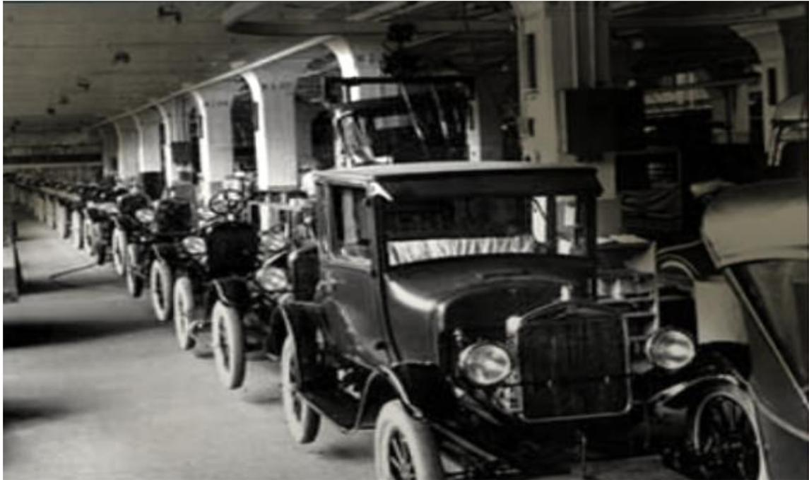
**简介：**1913年，福特凭借创新理念与反向思维，开创汽车组装流水线模式。汽车底盘在传送带上匀速移动，工人依序安装发动机、操控系统、车厢、方向盘、仪表、车灯、车窗玻璃、车轮等部件，直至整车组装完成。首条流水线将T型车组装时间从12小时28分锐减至90分钟，生产效率提高8倍，不仅大幅提升产品质量与产量，更有力推动生产工艺及产品标准化，为现代工业生产奠基。
