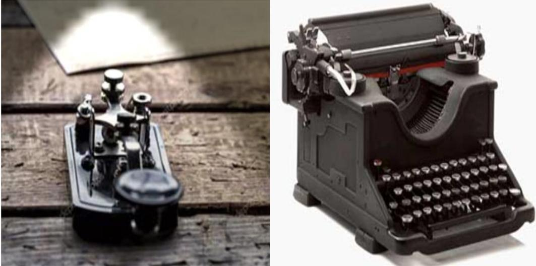
**简介：**1837 年，塞缪尔·莫尔斯发明电报机，此举标志着电报通讯的开端。他所设计的通讯电码由点、划符号组合而成，每个码对应一个字母或数字。发报员通过电键发送长短不同的电码，收报员接收时，能听到“滴”“答”声，其中“答”声时长为“滴”声的三倍。收报员抄录这些“滴”“答”组合的电码后，将其翻译为电文，这便是早期电报的运作方式。1844 年 5 月 24 日，莫尔斯从华盛顿向巴尔的摩成功发送首份电报，这一天被国际公认为电报发明日。莫尔斯发明的电报因采用独特电报编码，具备简单准确、经济实用的显著特点，为现代通信技术的发展奠定了重要基础。
