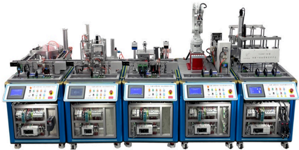
▲ 机电一体化设备实训平台
